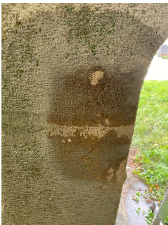
zkouška čištění – odstranění silnovrstvého nátěru
