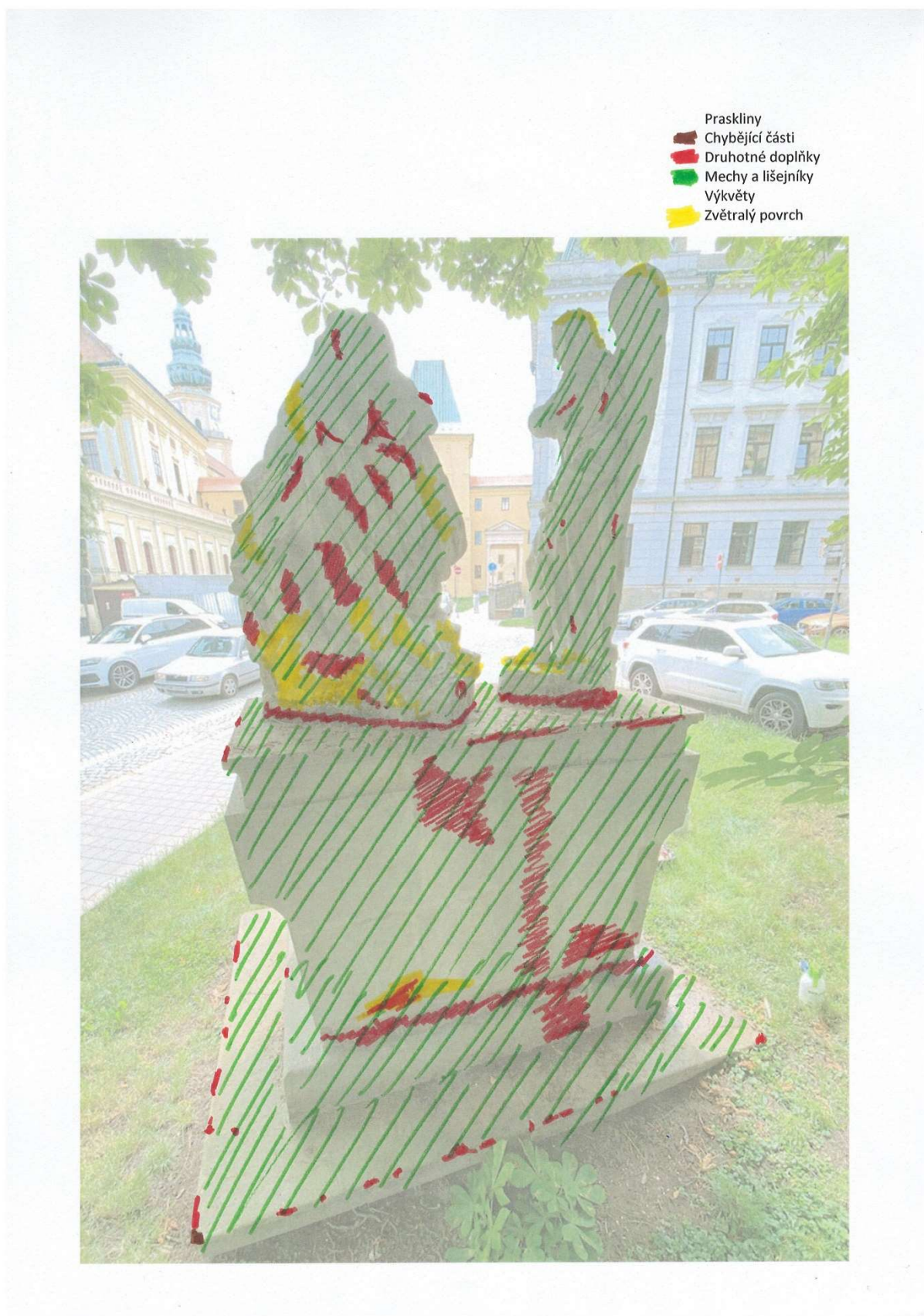
Zákres poškození: zadní strana sousoší
